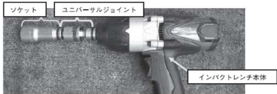
図-4.40 電動工具(インパクトレンチ)の例
