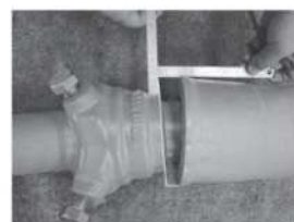
図-4.65 曲げ角度確認方法
