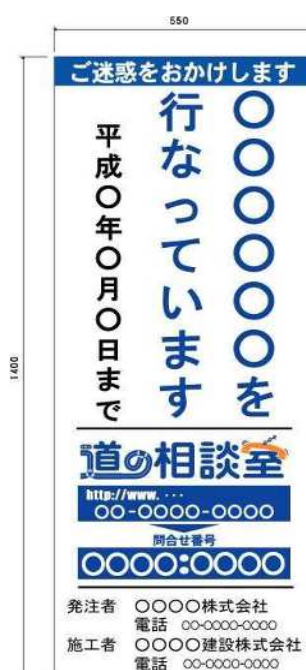
(様式4) 工事説明看板 (占用企業工事)
