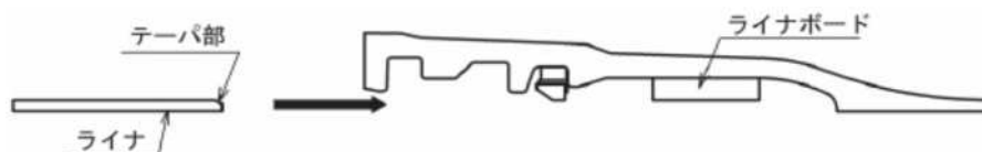
図-4.44 ライナのセット(呼び径 75～250)
