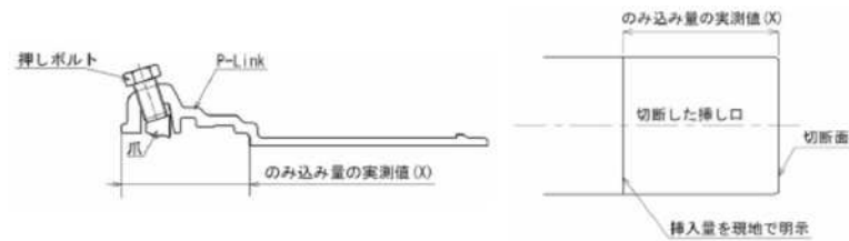
図-4.57 挿し口の挿入量(X)
