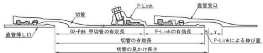
図-4.55 P-Linkを用いた切管有効長
