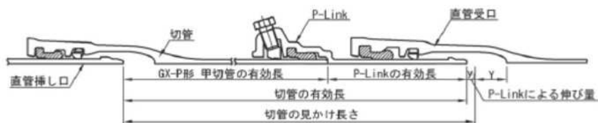
図-4.55 P-Linkを用いた切管有効長
