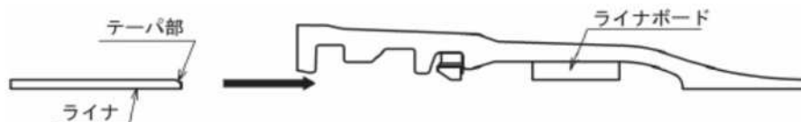
図-4.44 ライナのセット(呼び径 75~250)
