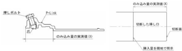
図-4.57 挿し口の挿入量(X)
