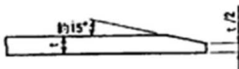
図-4.1 ゴム輪挿し口端の面取
