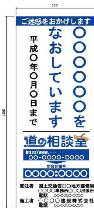
(様式2) 工事説明看板 (道路補修工事)
