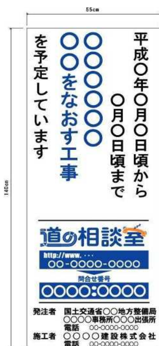
(様式1) 工事情報看板 (道路補修工事)
