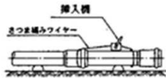
図-4.75 挿入機による挿し込み
