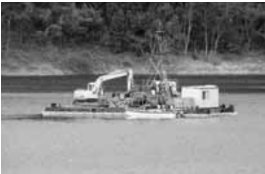
▲一ノ目潟の湖底を約40cmまで掘り下げ、ボーリング調査を行いました。
