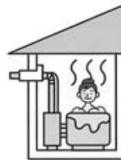
屋外から取り入れた空気で燃焼し、屋外に排気ガスを排出する自然給排気による密閉燃焼方式なので安全です。
