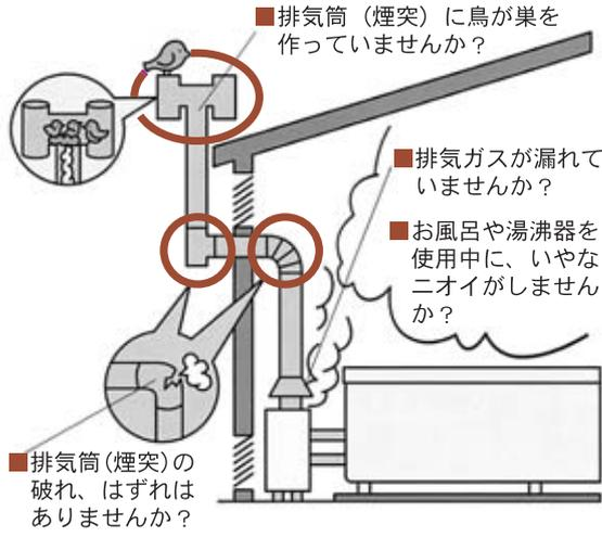
排気筒（煙突）式のガス機器は、○印の箇所を点検しましょう。
