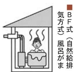
屋外から取り入れた空気で燃焼し、屋外に排気ガスを排出する自然給排気による密閉燃焼方式なので安全です。
