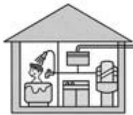
■B F式（自然給排気方式）風呂がま
